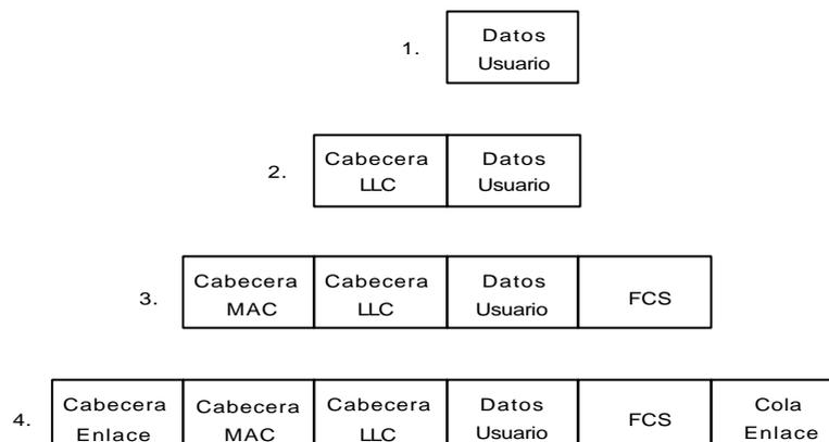
**Figura 1-4.** Encapsulación de datos en una conexión punto a punto
