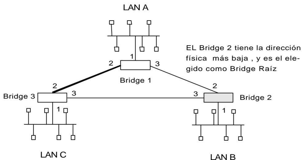
**Figura 2-1.** LANs de red antes de un spanning tree
