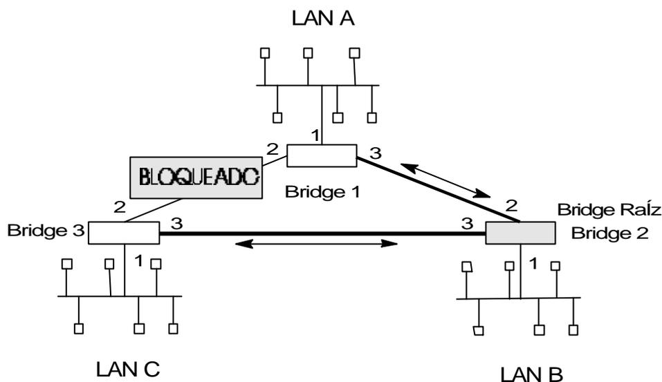
**Figura 2-2.** Spanning Tree creado con valores por omisión
