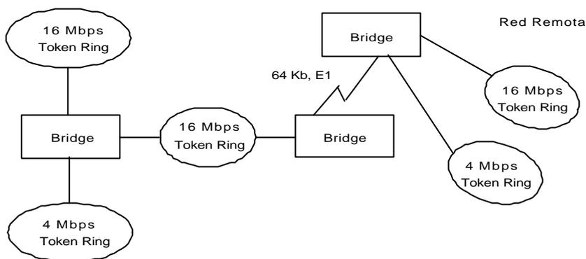
**Figura 3-1.** Muestra de la conectividad del bridge de source routing
