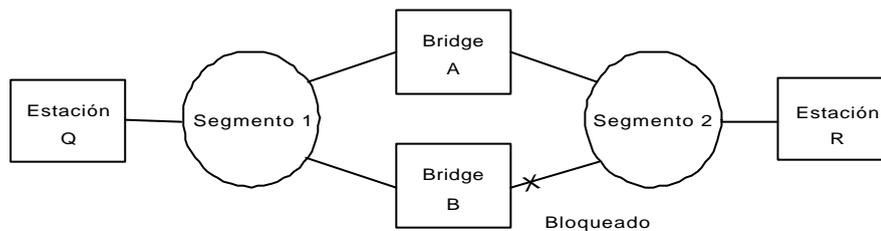
**Figura 3-4.** Muestra de Bridge Paralelo
