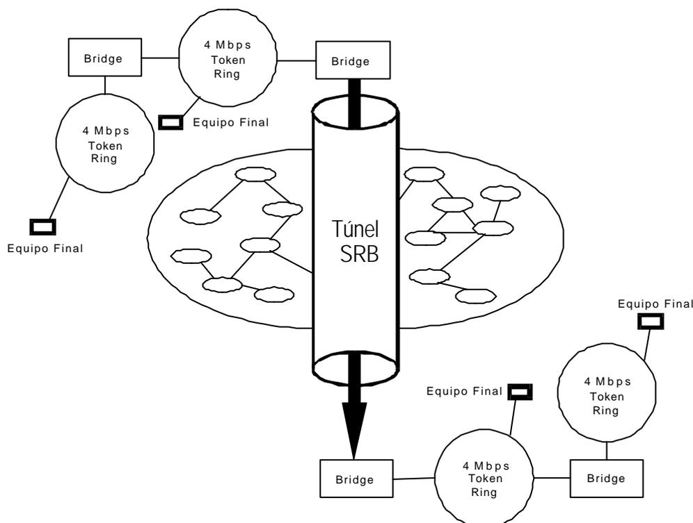
**Figura 6.1.** Los equipos finales ven el routing a través de una internet IP compleja como un salto
