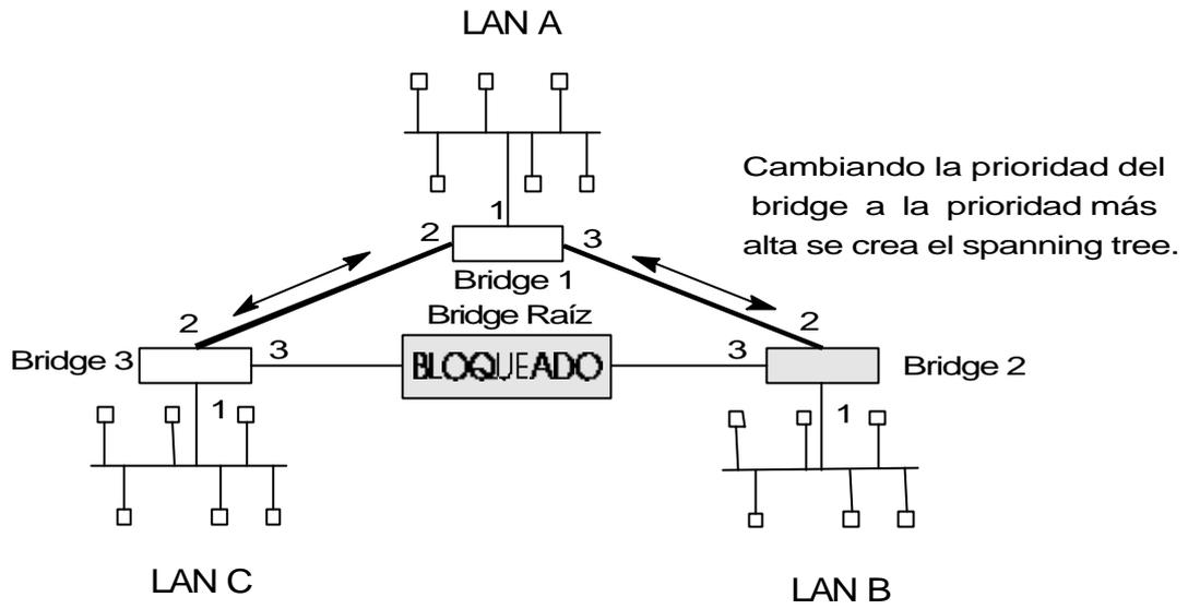
Figura 2-3. Spanning tree ajustado por el usuario
