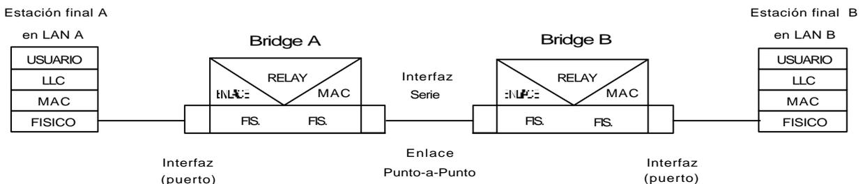
**Figura 1-3.** Bridging en una conexión punto a punto
