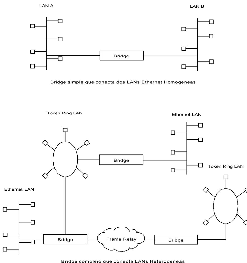
**Figura 1-1.** Configuraciones de Bridging homogéneas y heterogéneas
