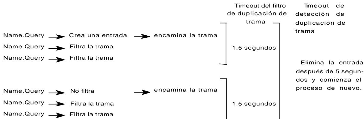
**Figura 9-2.** Proceso de filtrado de trama duplicada para tráfico de bridge
