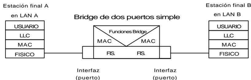
**Figura 1-2.** Bridge de dos extremos que conectan dos LANs
