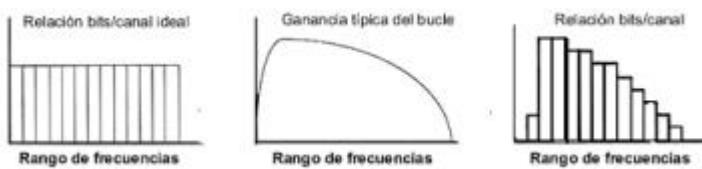
Sea cual sea la técnica de modulación utilizada, el estándar ANSI T1.413 especifica que ADSL debe utilizar **Multiplexación por División en la Frecuencia (FDM)** o **Cancelación de Eco** para conseguir una comunicación full-duplex. Ambas técnicas reservan los subcanales más bajos para la voz analógica.
