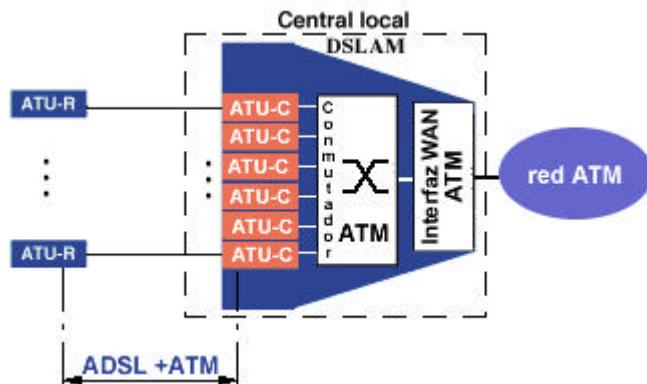
Teniendo en cuenta estas ventajas que nos ofrece el protocolo ATM la solución que se ha tomado para ofrecer servicios es el **envío de células ATM sobre el enlace ADSL (entre el ATU-R y el ATU-C situado en el DSLAM)**.
