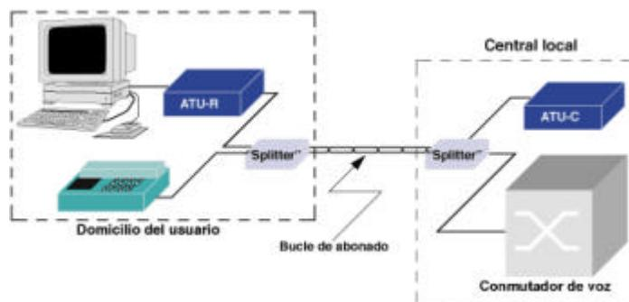
Al tratarse de una modulación en la que se transmiten diferentes caudales en los sentidos Usuario -> Red y Red -> Usuario, el módem ADSL situado en el extremo del **usuario** (ATU-R o "ADSL Terminal Unit-Remote") es distinto del ubicado al otro lado del bucle, en la **central local** (ATU-C o "ADSL Terminal Unit-Central").
